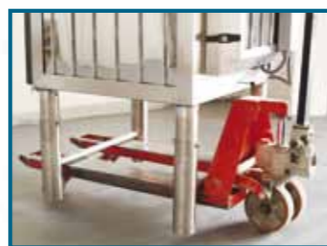
Podstavec s příčnými výztuhami pro snadnou manipulaci pomocí paletového vozíku
