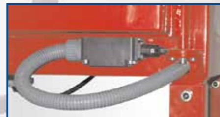
Schválený bezpečnostní vypínač dveří s vynucením vypnutí. Schválený bezpečnostný vypínač dverí s donútením vypnutia.
