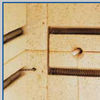
Platinum – Rhodium – čidlo pro měření teploty bez opotřebení, chráněné proti poškození. Platinum – Rhodium – čidlo na meranie teploty bez opotrebenia chránené proti poškodeniu.
