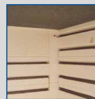
R- SIC deska proti znečištění prachem ze stropu pece. R- SIC doska proti znečisteniu prachom na strope pece.
